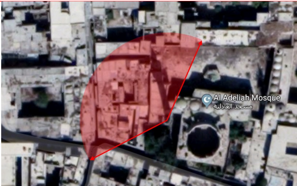
منطقة الخطر في حال سقوط المنذنة Danger area in case of the minaret collapse ( Syrian Heritage Archive Project 2019)
